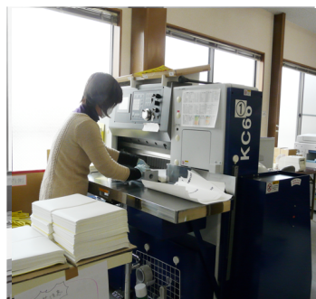
紙の伸縮によるトンボのズレをバックゲージで補正して簡単に見当合わせが行える「KC66」
